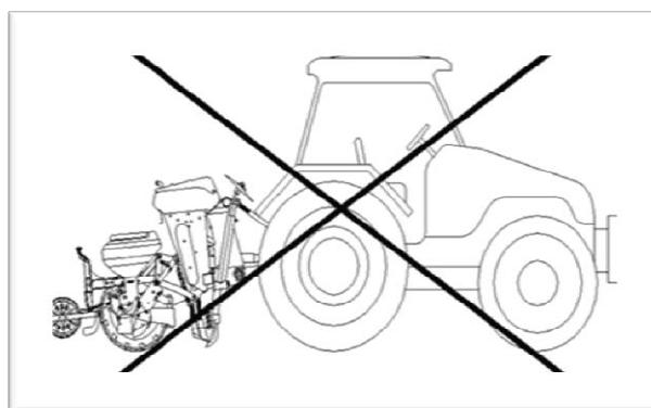
Неправилно прицврстување: Сеалката е навалена нанапред или наназад
